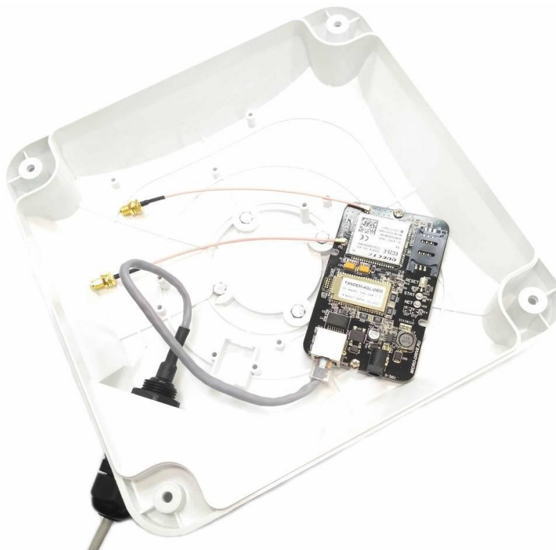
Рис.6.1. Монтаж в герметичную антенну Antex Unibox.
